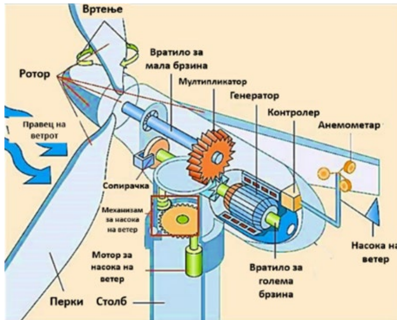
Слика 6. Шема за ветерните турбини за ветерен парк „Вирово“
