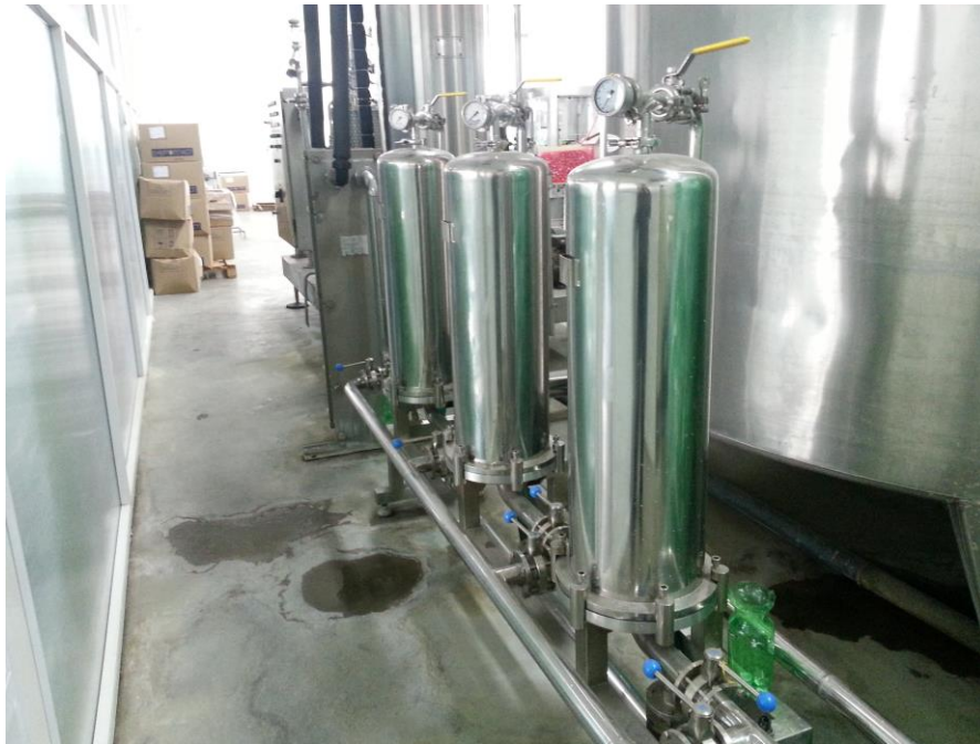
Слика бр. 24 Трестепена филтрација
