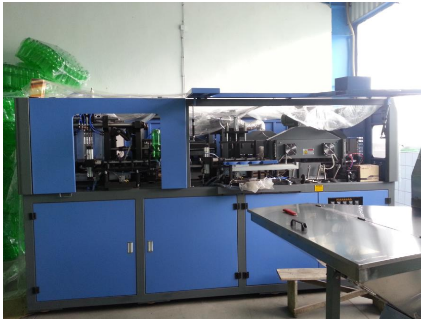
Слика бр. 23 Машина за дување на шишиња
