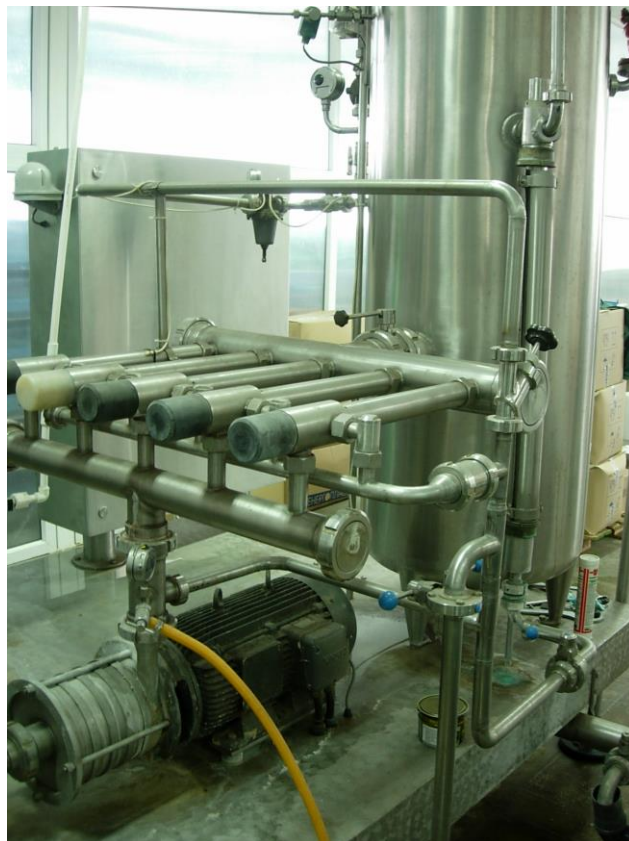
Слика бр. 25 Машина за мешање на вода со CO 2
