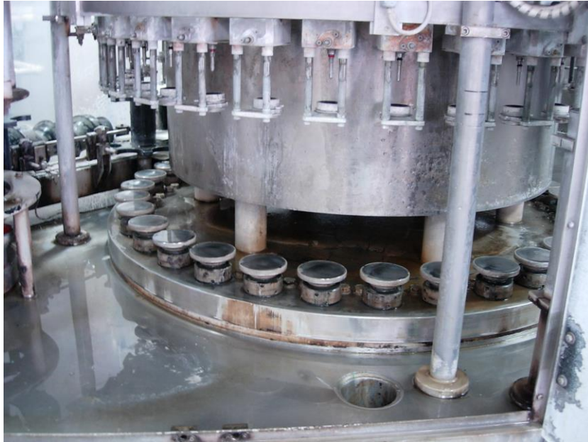
Слика бр. 26 Машина за плакнење, полнење и затворање
