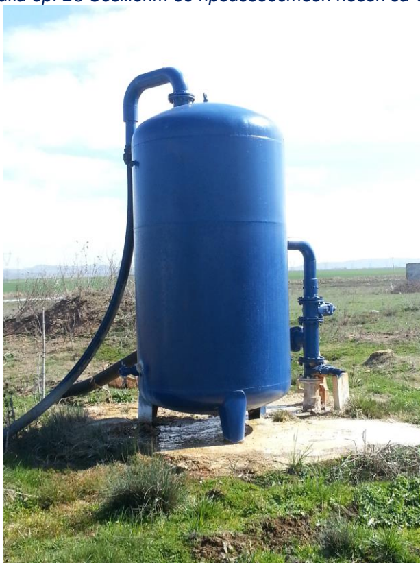
Слика бр.27 Извирање, сепарирање на суров гас од вода-Д-3
