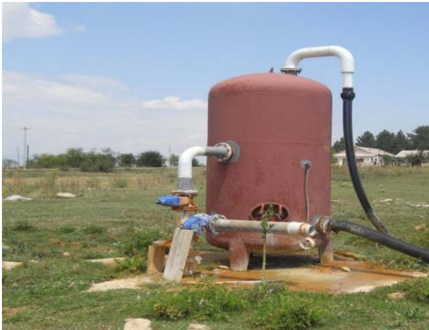
Слика бр.24 Сепаратор поставен на дупнатина Д-3 за одвојување на гасот \text{CO}_2 од минарална вода
