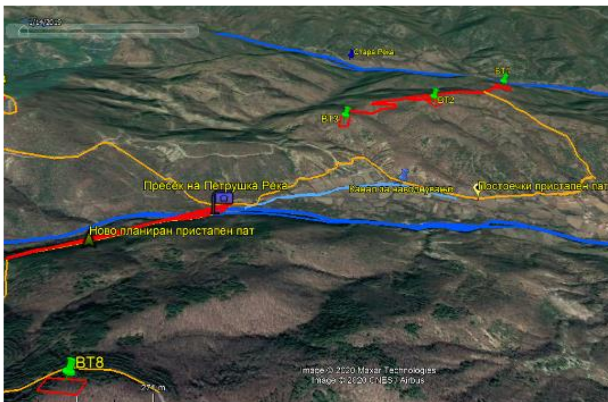
Слика 67 Пресек на пристапниот пат до ВТ8, ВТ9, ВТ10, ВТ11 и ВТ12 со Петрушка Река и близината на канал за наводнување до главниот пристапен пат
