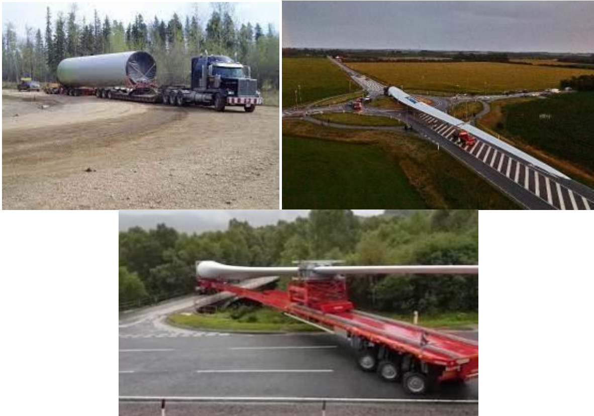
Слика 16 Транспорт на делови од ветерна турбина (Извор: Google)
