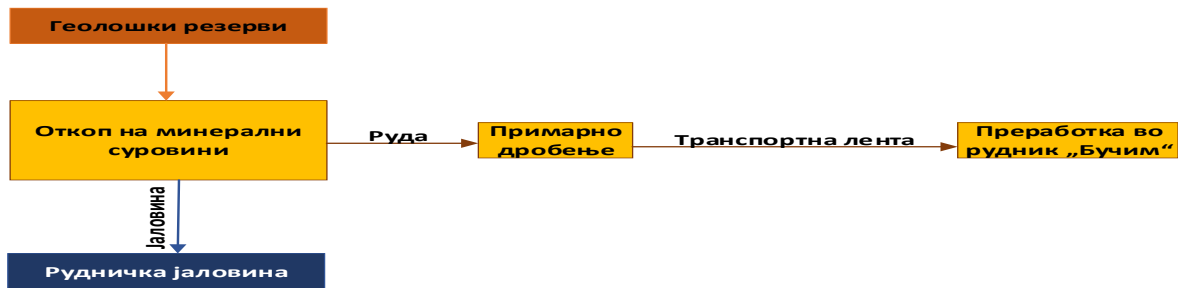
Шематски приказ на процесот на експлоатација и преработка на минералните сировини во рудник „Боров Дол“
