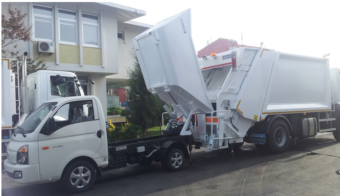
Слика 11 Секундарно собирање: Мал камион отпад го товари отпадот во поголем камион со збивање
