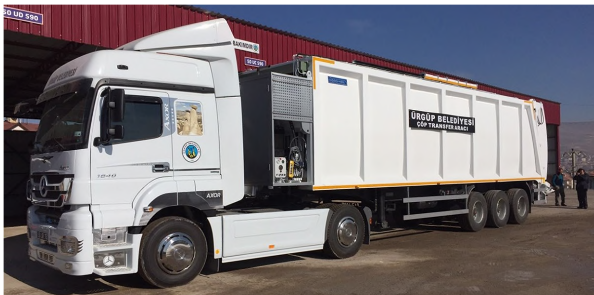
Слика 16 Шлепер и полуприколка со автоматски-управувана единица за збивање
