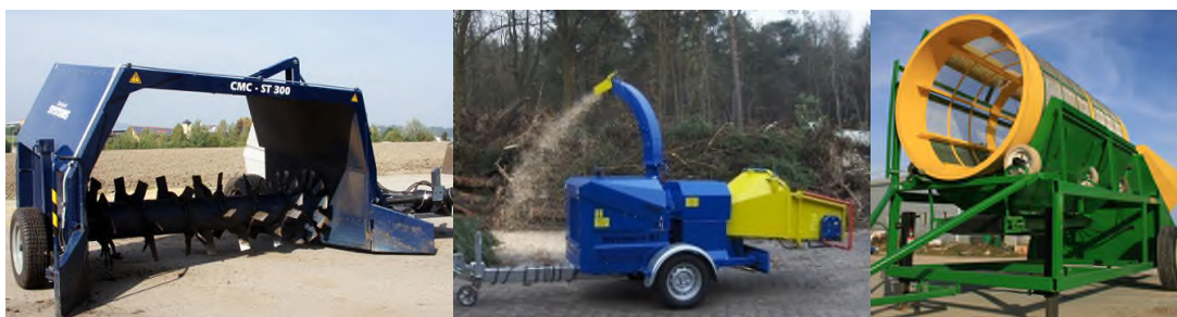
Слика 20 Тип на превртување со потис на лента 8 (I.), режач 9 , барабанско сито 10
