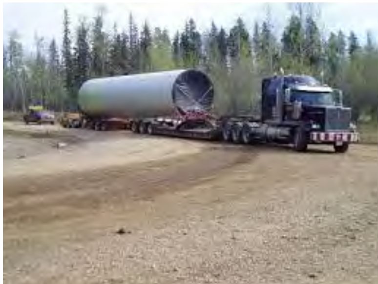
Слика 14 Транспорт на делови од носечки столб на ветерна турбина (Извор: Google)
