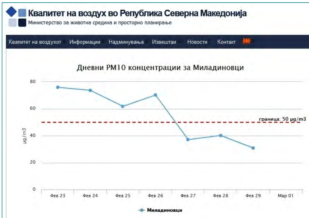
Слика бр.5-10: Дневни концентрациина на PM10 за мерна станица Миладиновци (Извор: http://air.moerpp.gov.mk/?page_id=175# )
