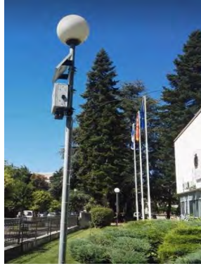
Слика 39. Сензор за индикативно следење на еколошки параметри за квалитет на воздухот во Охрид
