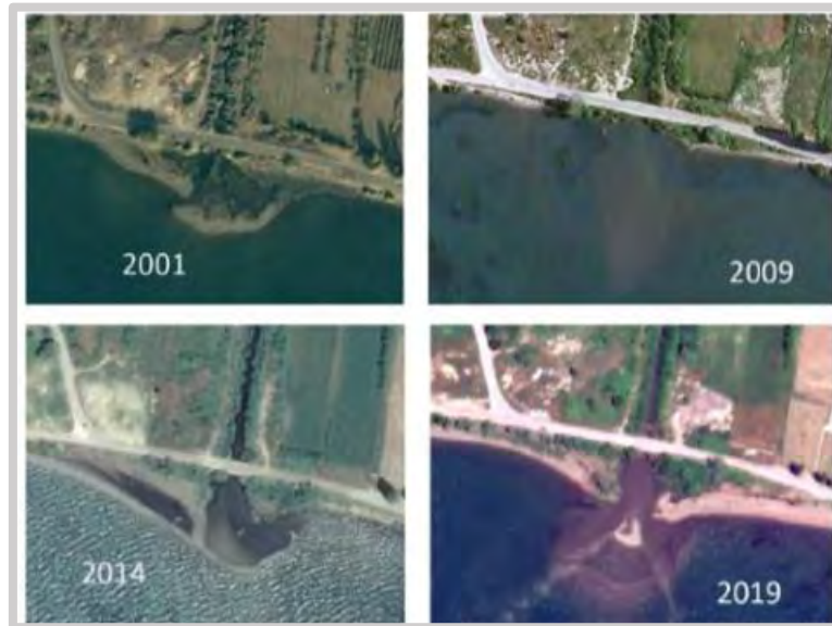
Слика 7. Депониран нанос на вливот на реката Сатеска и примените низ годините (сателитска снимка од Google Earth)
