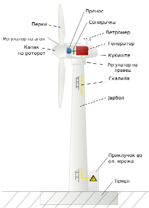
Слика 2 Составни делови на ветерна турбина
