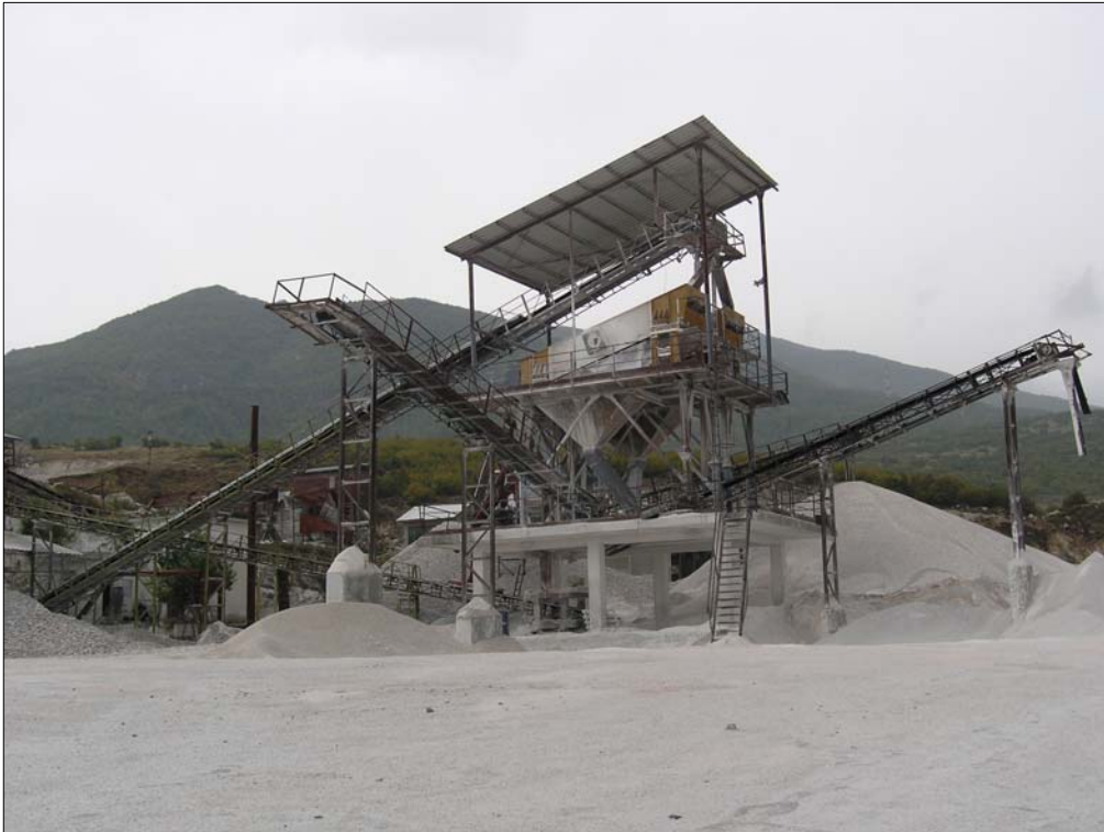
Сл.бр.6 Сува постапка на преработување на варовник
