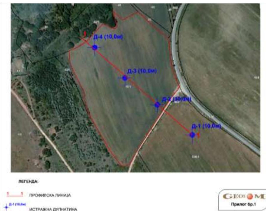
Слика 5 Истражни дупнатини
