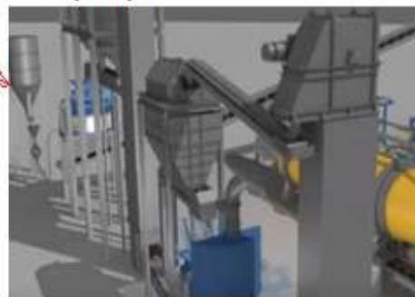
Транспортна лента за песок до ладилник и силоси
