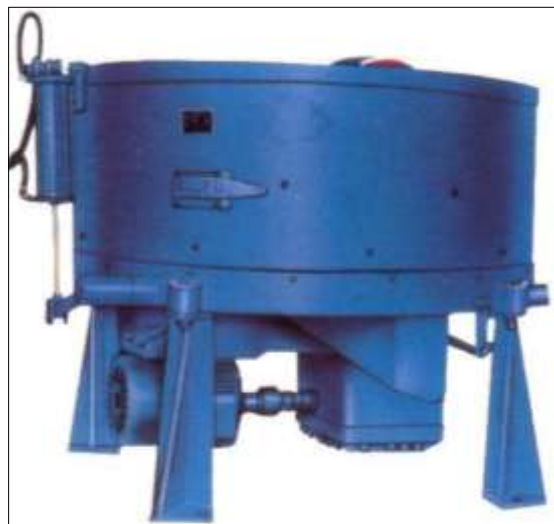
Слика 14 Мешалица за припрема на калапарска мешавина
