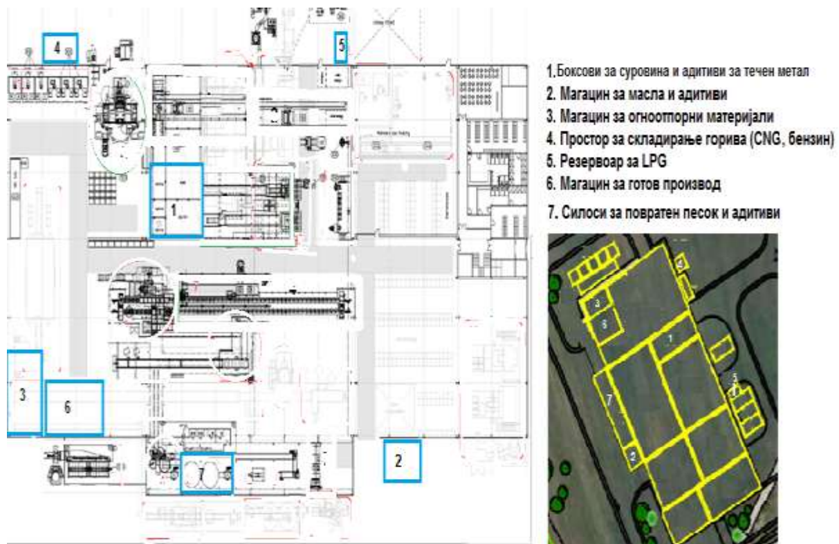
Слика 13 Магацини за складирање сировина и помошни материјали шематски приказ и google снимка
