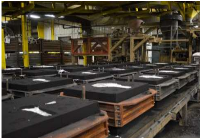
Слика 16 Подвижна калапарска линија
