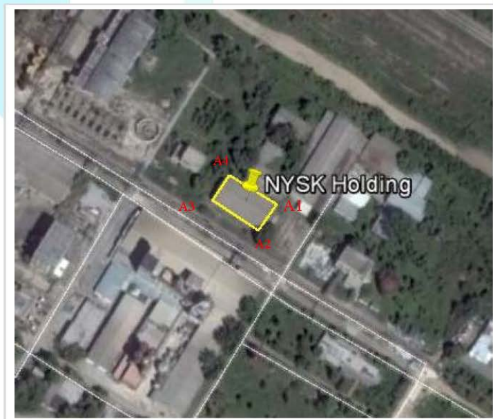
Слика бр. 3 : Мерни места каде се извршени мерења на ниво на бучава во животна средина
