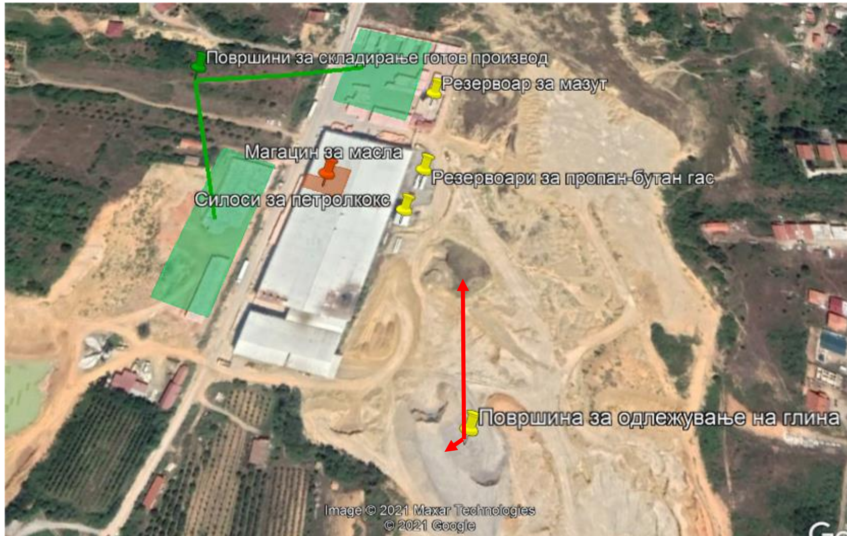
Слика 25 Површини и магацински простор за складирање суровина, помошни материјали (google снимка)
