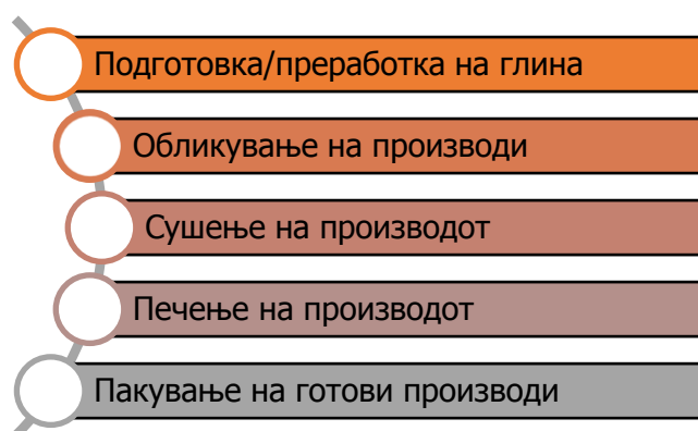
Слика 5 Шематски приказ на процесот на производство на градежна керамика
