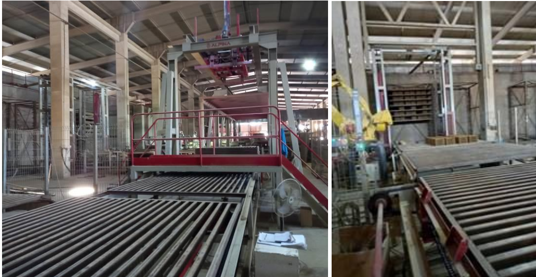
Слика 27 Рафтови за полупроизвод и регали за пренос во сушара
