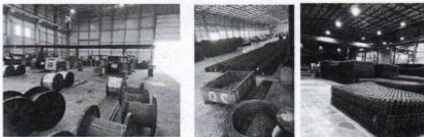
Слика 9 Оддел „Bakarисување“ производство и намотување на жица за заварување по MIG постапка
