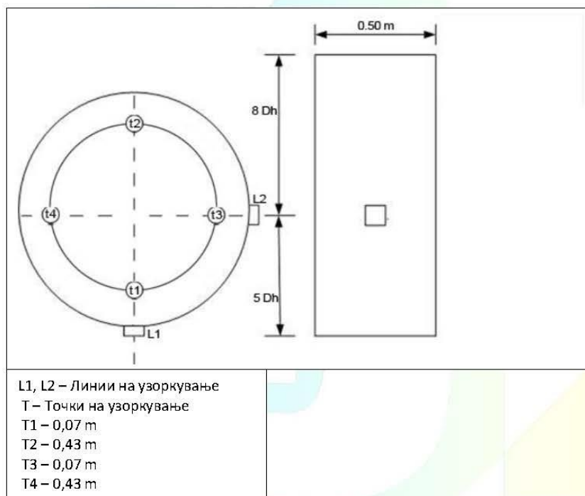
Слика бр. 1: Шематски приказ на мерни линии и мерни точки од котел бр. 1 и котел бр. 2
