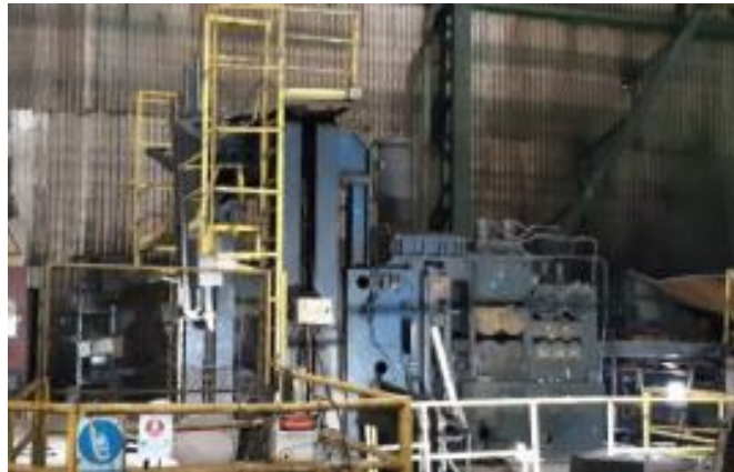
Слика бр. 4: Влезен дел во Лужилница и Процесор (кршач на коварина, влечни валци и рамналка)
