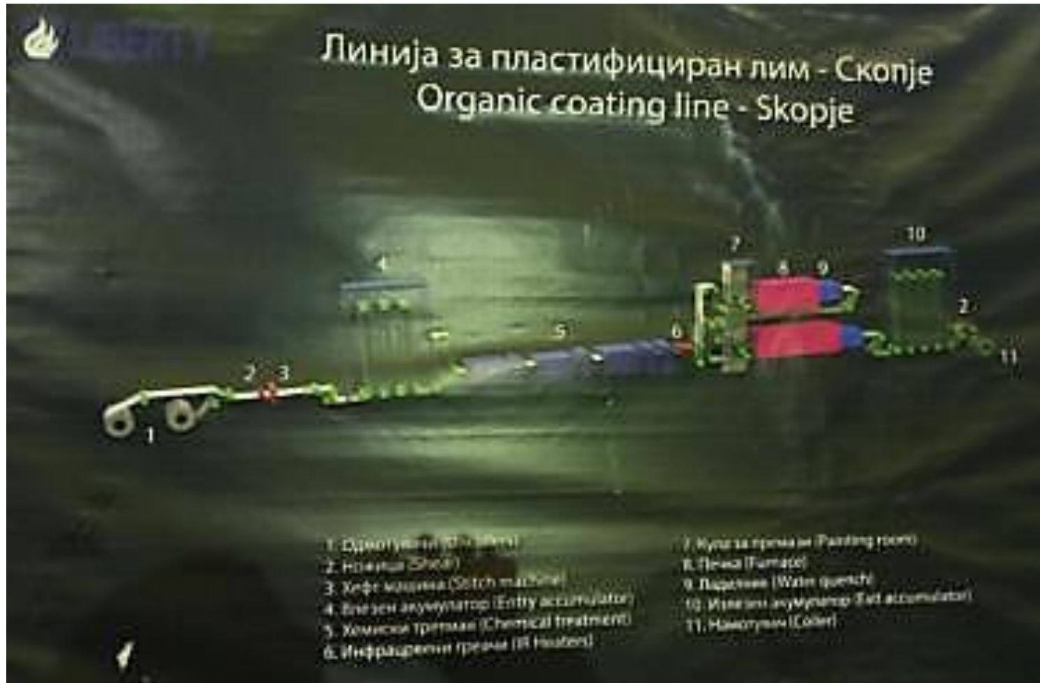
Слика бр. II.1-4: Шематски приказ на линија за пластификација
