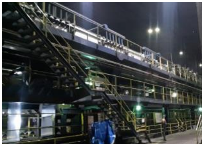
Слика бр. 15: Печка на линија за поцинкување
