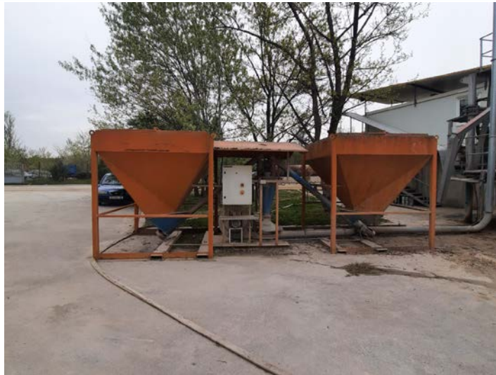
Слика бр. 9: Силоси за дозирање на целулоза
