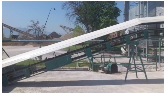
Слика бр. 5: Транспортни ленти за дозиран сепариран дробен камен
