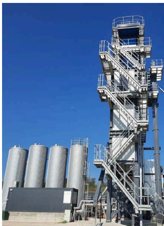
Слика 6 Елеватор, сито, бункери, контролна кабина - контејнер
