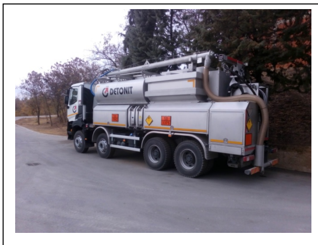
Слика II.4 и 5: Возило (MEMU) за превоз на опасни супстанции
