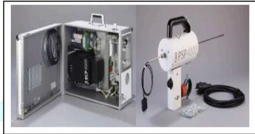
Слика бр. 7.3 и 7.4: Гасен анализатор PG 350E HORIBA со придружната опрема
