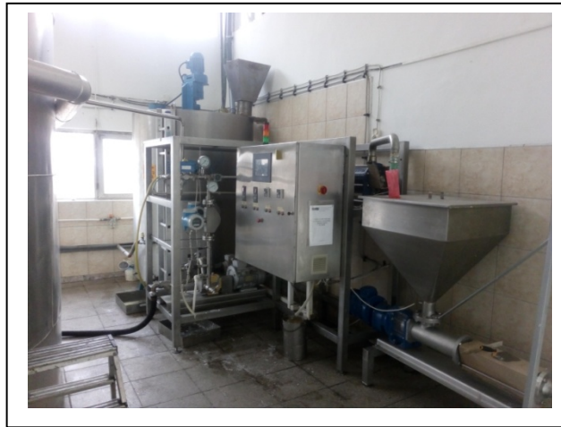
Слика II.1-3: Резервоар за уљна фаза и линија за производство на емулзиона матрица
