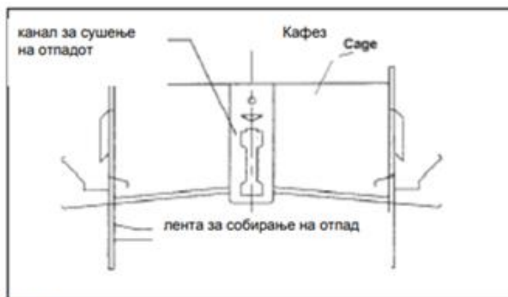
Слика бр. 5 - Шематски приказ на кафезите со детален приказ на секој од елементите
