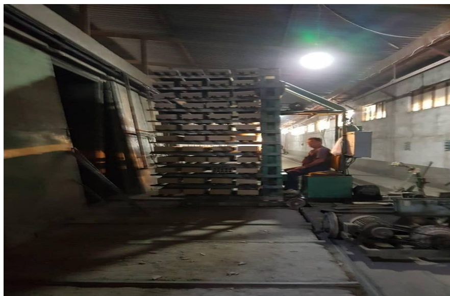
Слика бр. 12 Вадење на исушените производи од сушарите
