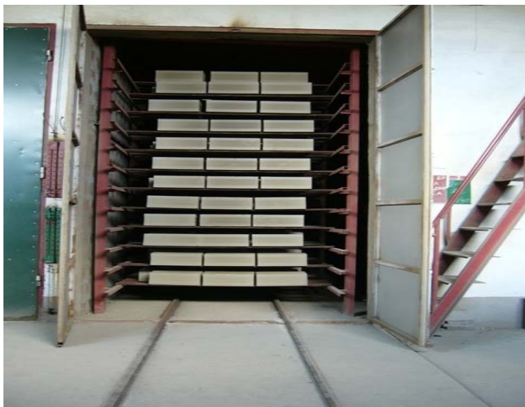
Слика бр. 10 Сушење на производи во сушари
