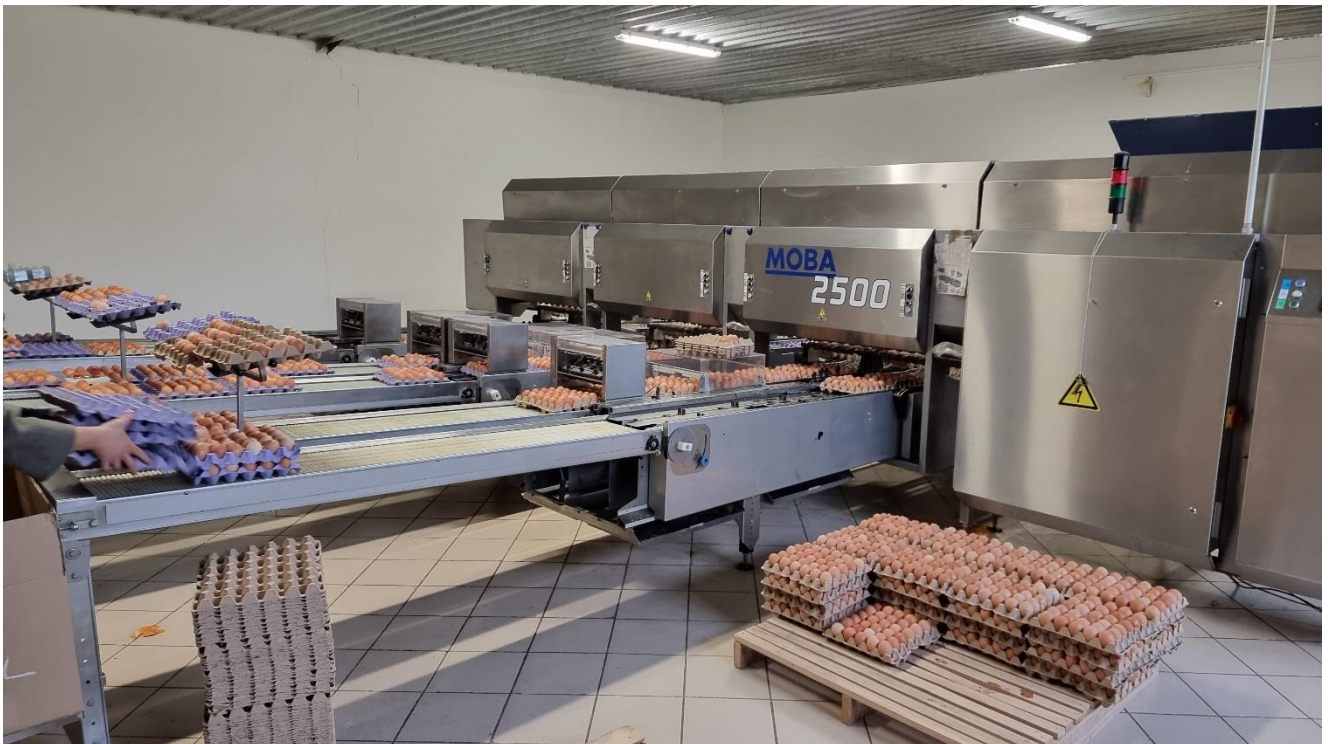
Слика II.2.4-5 и II.2.4-6: Инсталирана опрема МОБА 2500 за сортирање и пакување
