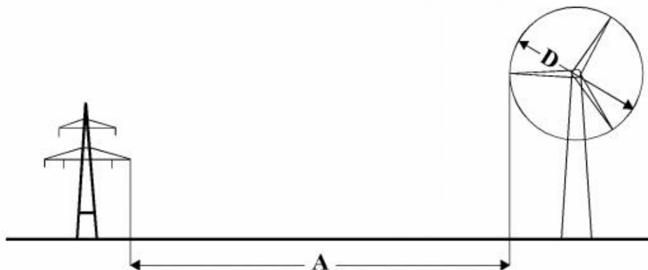
Слика 15: Надземен вод > 45 kV
