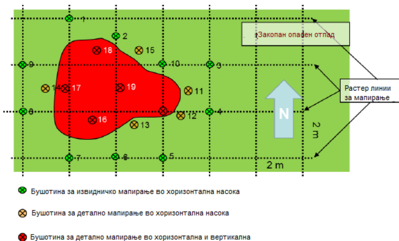
Слика 3.2 Пример на план за дупчење за истражување на јама
