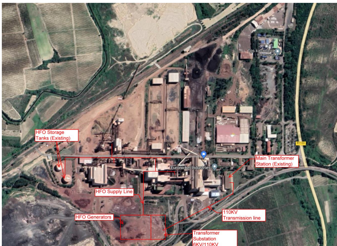
Слика 2: Приказ на локацијата на планираните генератори како и новите линии за поврзување на истите со постоечкиот енергетски систем и системот за дистрибуција на мазут
