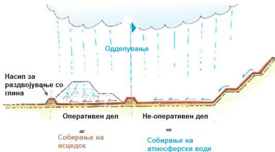
Слика 6: Попречниот дел на депонијата со означениот систем за сепарација во оддели (во оперативните и не-оперативните фази) и поврзаниот систем за собирање на исцедокот и атмосферската вода
