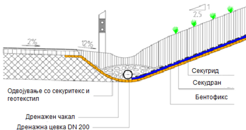
Слика 8: Поставување на геосинтетички материјали и дренажни цевки
