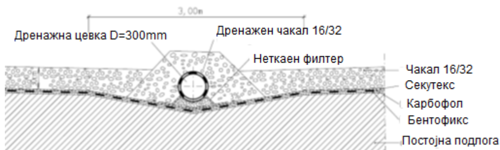
Слика 7: Дренажен систем за собирање на исцедокот
