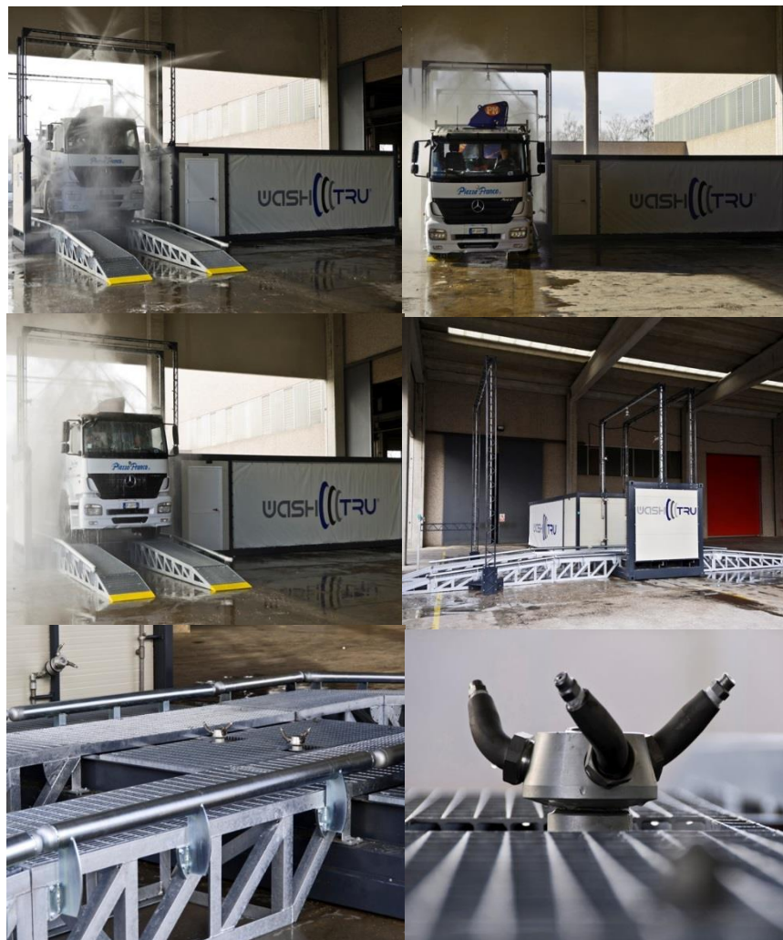
Слика 42: WASHTRU мобилна станица за перење на камиони и возила
