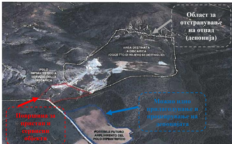
Слика 3: Воздушен приказ на локацијата на депонијата за инертен и неопасен индустриски отпад, со трите главни структурни дела
