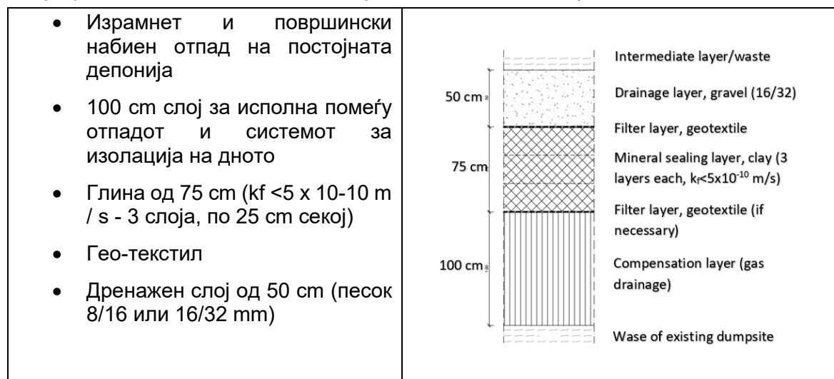
Слика 3 Профил на систем за изолација на дното на депонијата
