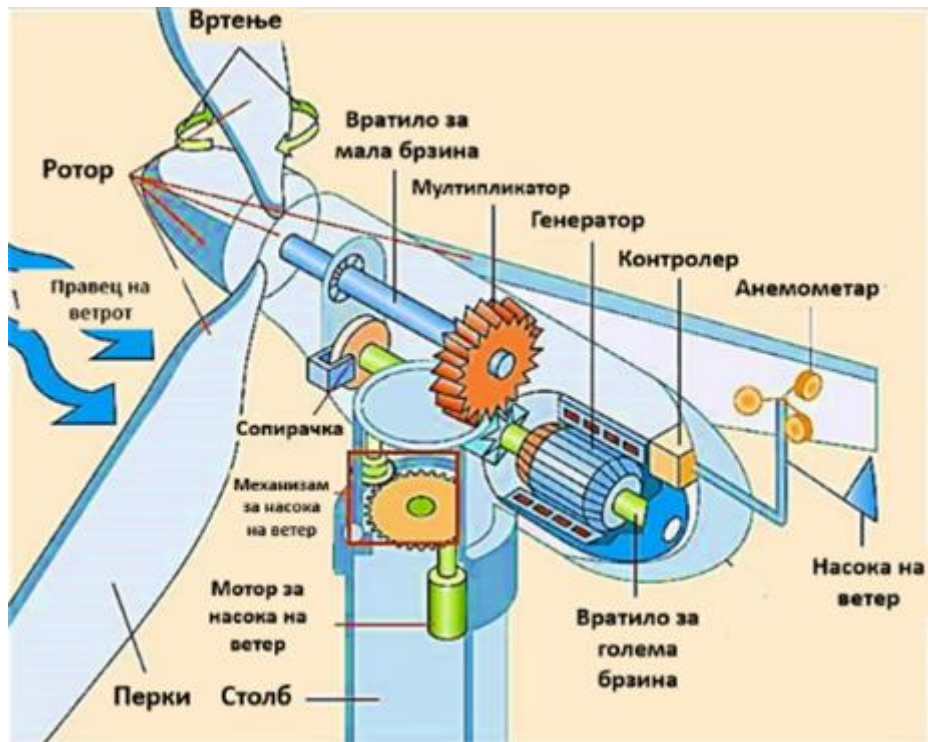
Слика 2: Шема за ветерните турбини за ветерен парк Рамно
