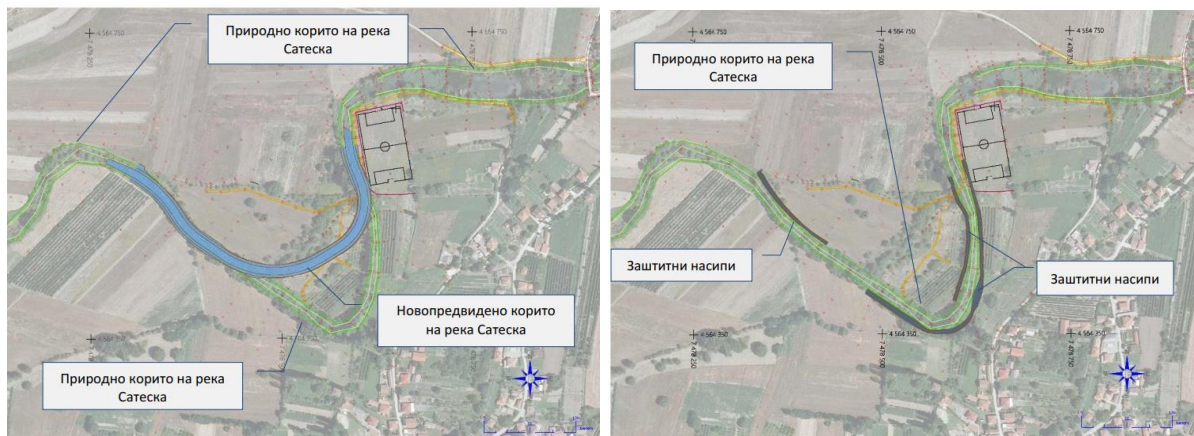
Слика 5 Подобрување на капацитетот на река Сатеска - Делница 2 - Алтернатива 1 (лево) и Алтернатива 2 (десно)
