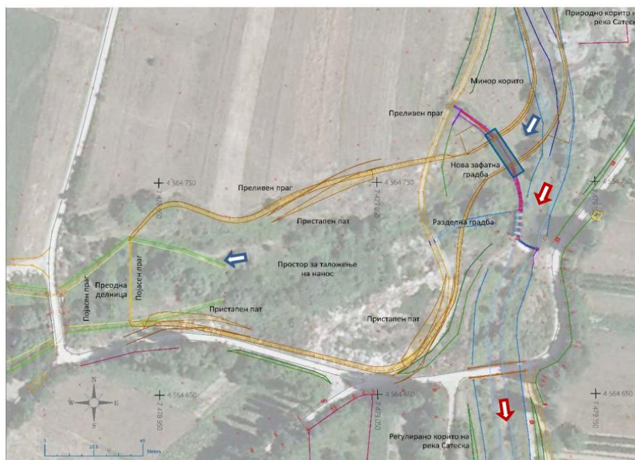
Слика 8 Свртување на коритото на река Сатеска и зафаќање на предвидените количини - Алтернатива 2
