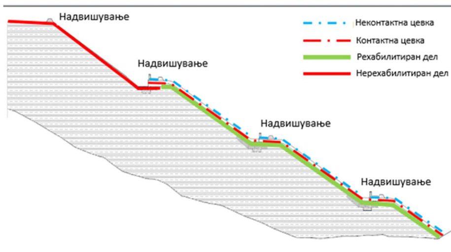
Слика 52 Типичен пресек на насип на Инсталацијата за суво одлагање, со цел да се прикаже управувањето со контактни и неконтактни води
