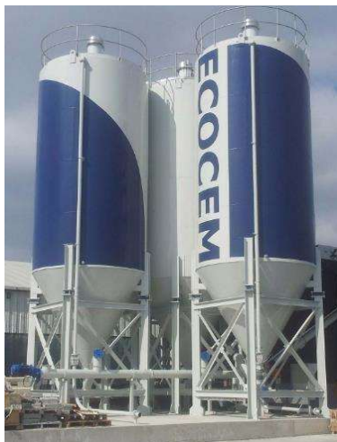
Слика 33 Типични силоси за цемент
