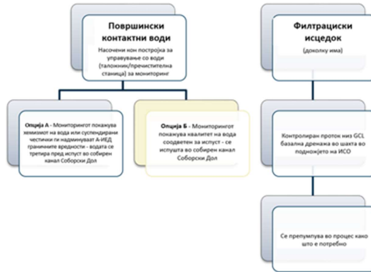
Слика 2.4: Приказ на текот на процесот на управување со контактни води
