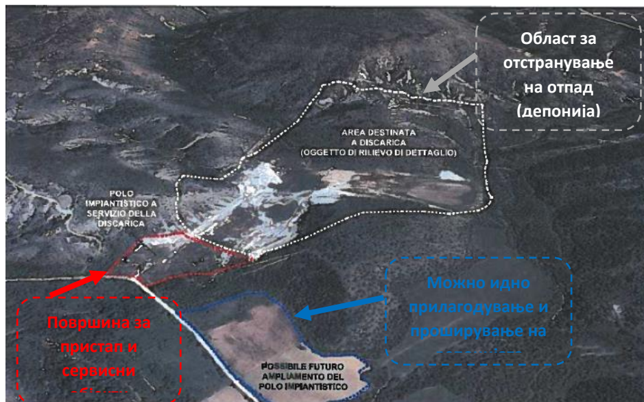
Слика 2 : Воздушен приказ на локацијата на депонијата за инертен и неопасен индустриски отпад, со трите главни структурни дела
