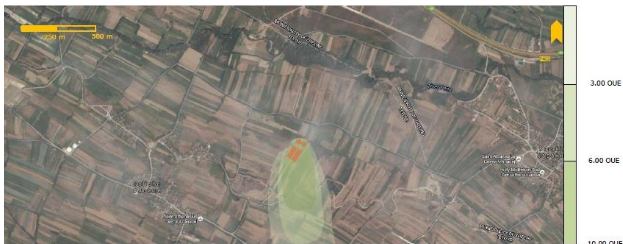
Слика 40 Модел на дисперзија на мириси – просечни 24 часовни концентрации (правек на ветер север)
