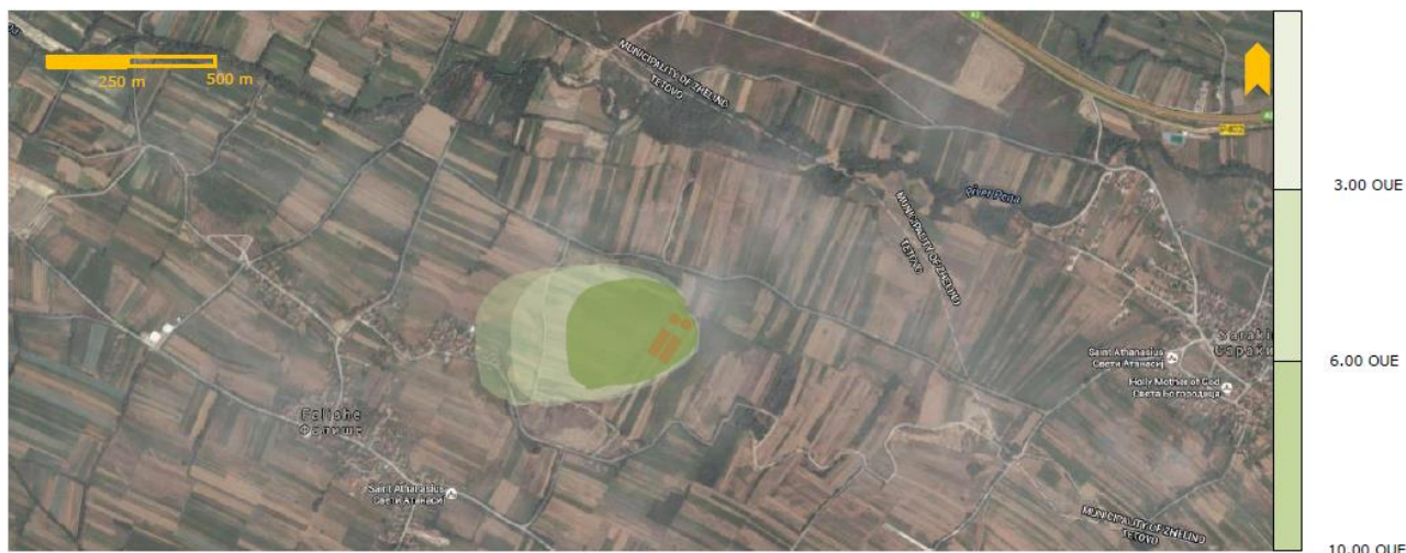
Слика 42 Модел на на дисперзија на мириси – просечни 24 часовни концентрации (праец на ветер запад)
