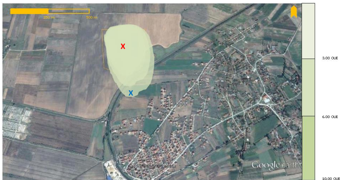
Слика 41 Модел на на дисперзија на мириси – просечни 24 часовни концентрации (правец на ветер југ)
