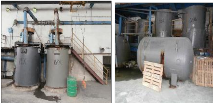
Слика 38 Просторија за подготовка и складирање на раствори (KEX, KAX, \text{CuSO}_4 , \text{ZnSO}_4 )
