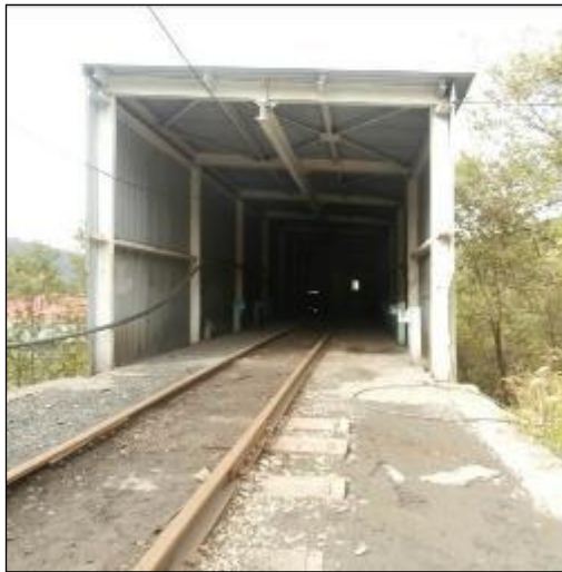
Слика 30 Транспорт на рудата во погонот за дробење и влез во приемниот бункер
