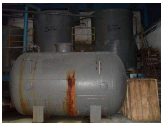
Слика 10 Резервоари за складирање на раствори од хемикалии
