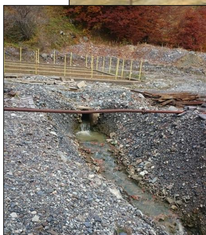
Слика 25 Таложник за јамска вода и испуст во Тораничка Река (поткоп II А)
