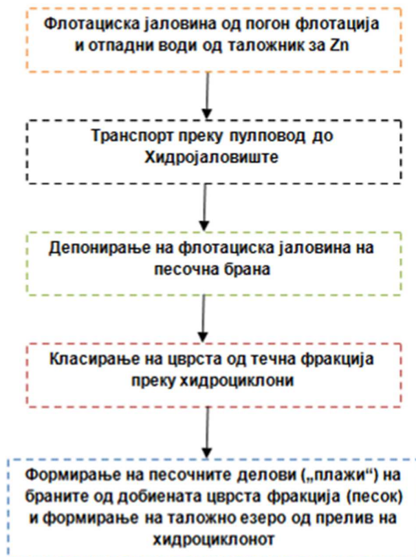
Слика 25 Шематски прика на транспорт и депонирање на флотациска јаловина Подетален опис за хидројаловиштето како и начинот на транспортирање и депонирање, на флотациската јаловина е даден во Прилог II.
