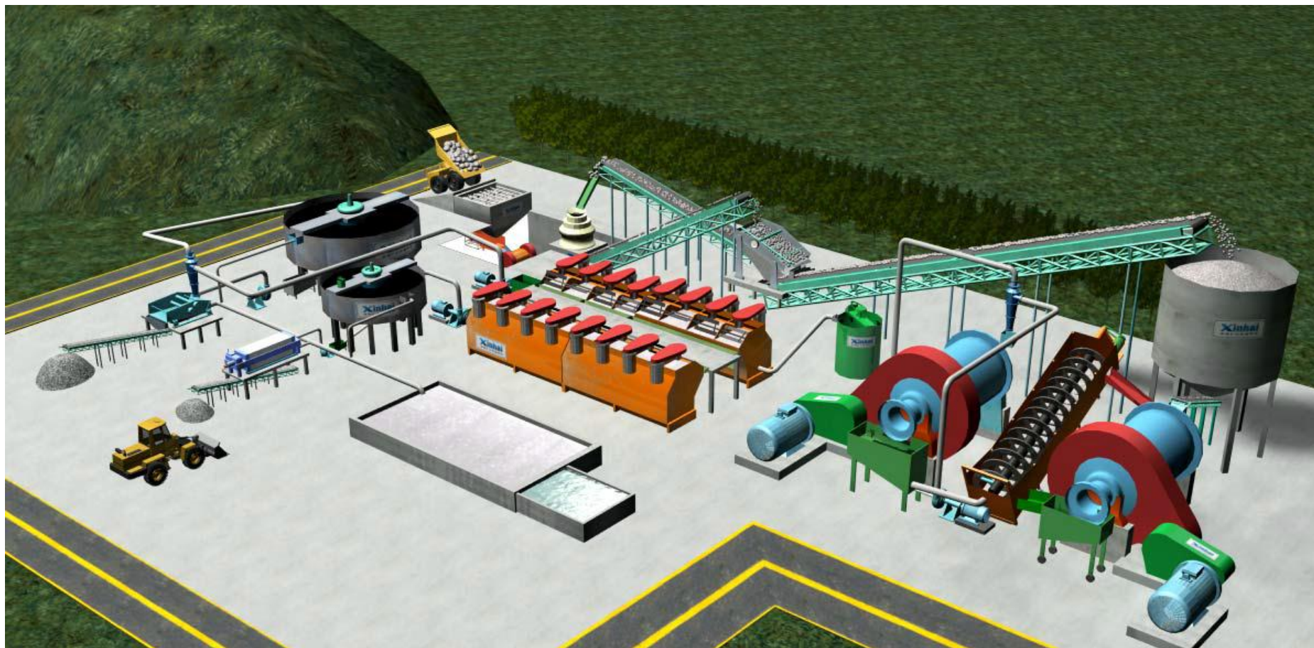
Слика 90 Технолошка шема на производниот процес за добивање на концентрати од олово и цинк
