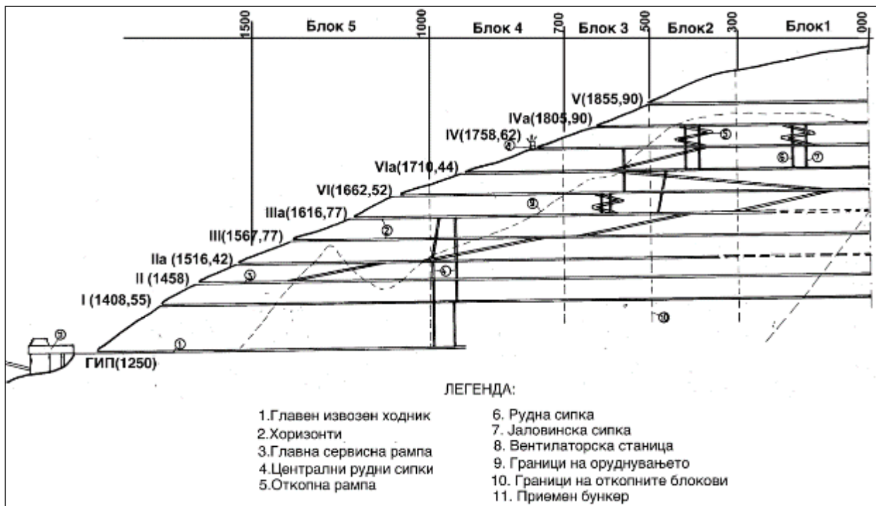
Слика 77 Надолжен пресек на рудникот, со поделба на поткоп-хоризонти и откопни блокови
