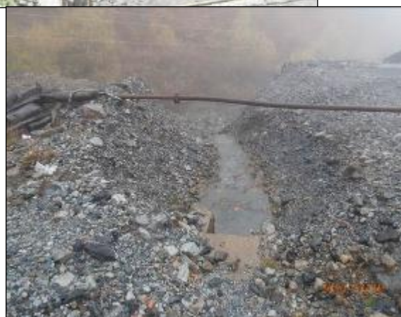
Слика 25 Таложник за јамска вода и испуст во Тораничка Река (поткоп II А)
