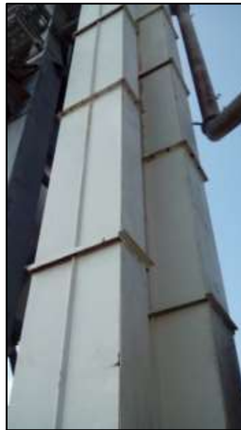
Слика 10. Механизам за транспорт на загреан агрегат
