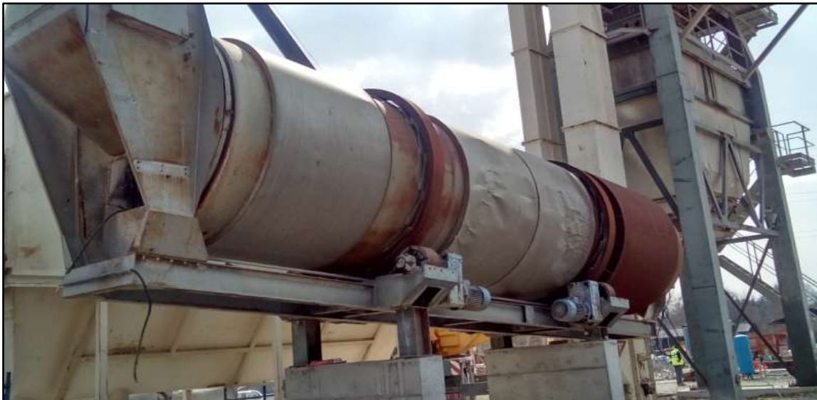
Слика 9. Механизам за сушење и загревање на агрегатот-сушилник
