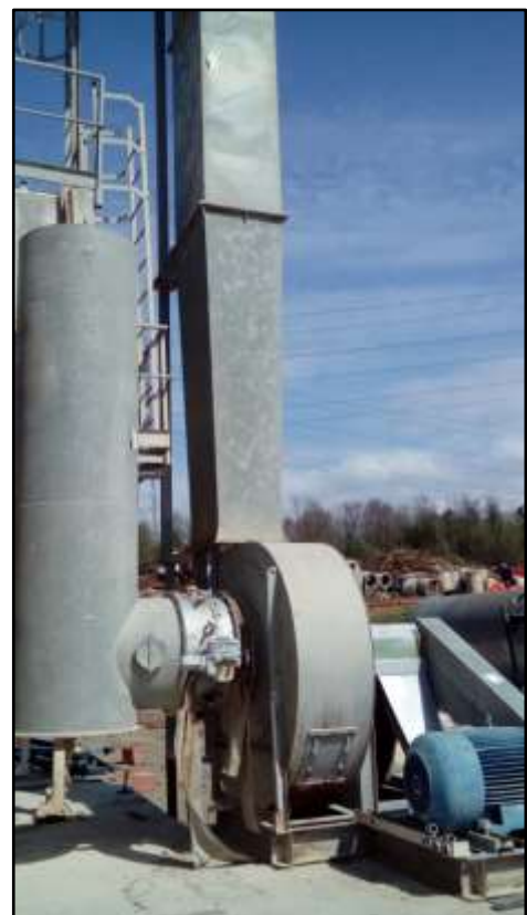
Слика 14. Систем за отпрашување на асфалтна база
