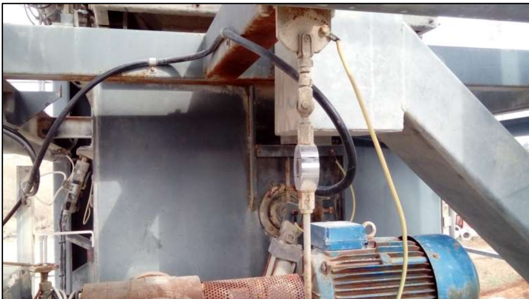
Слика 13. Автоматизиран систем за дозирање и мерење на материјалите
