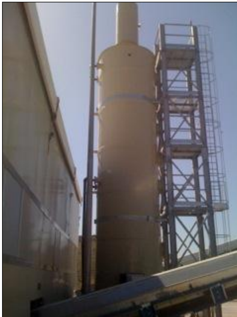
Слика 27 Изглед на предвидениот скрубера во постројката
