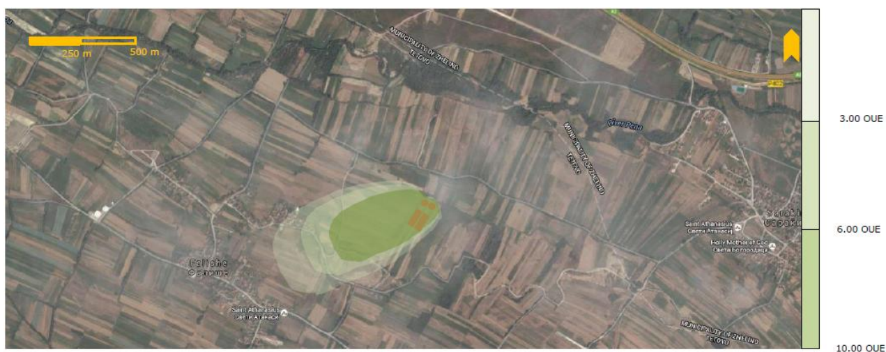
Слика 41 Модел на на дисперзија на мириси – просечни 24 часовни концентрации (праец на ветер југозапад)
