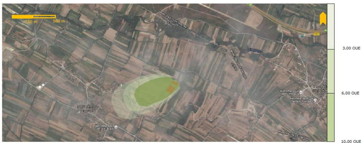
Слика 38 Модел на на дисперзија на мириси – просечни 24 часовни концентрации (праец на ветер југозапад)
