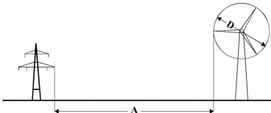
Слика 50: Надземен вод > 45 kV
