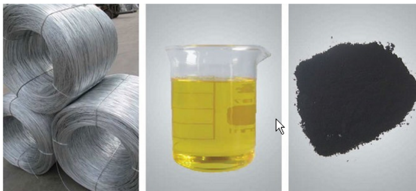
Слика 2-1. Излезни продукти од процесот на пиролиза на гуми – челична жица, пиролизно масло и пиролизен јаглен
