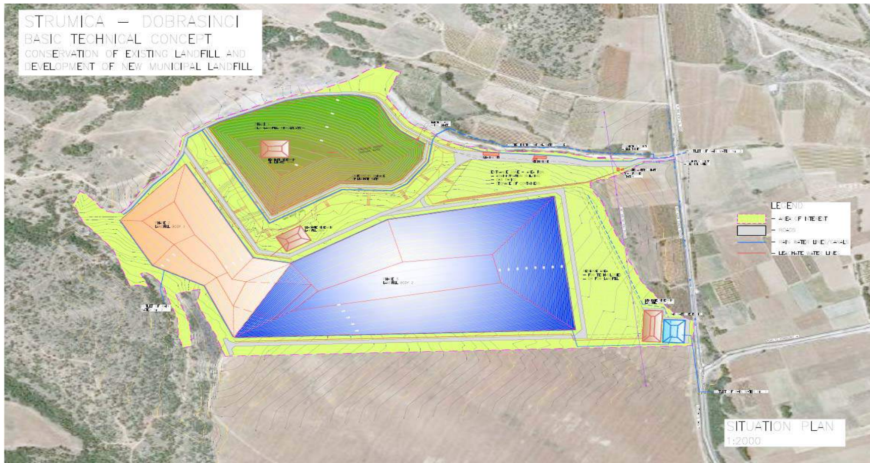
Слика 12. Технички концепт за затворање на постојната и отворање нова регионална депонија Доброшинци (извор: ASA study, 2012)
