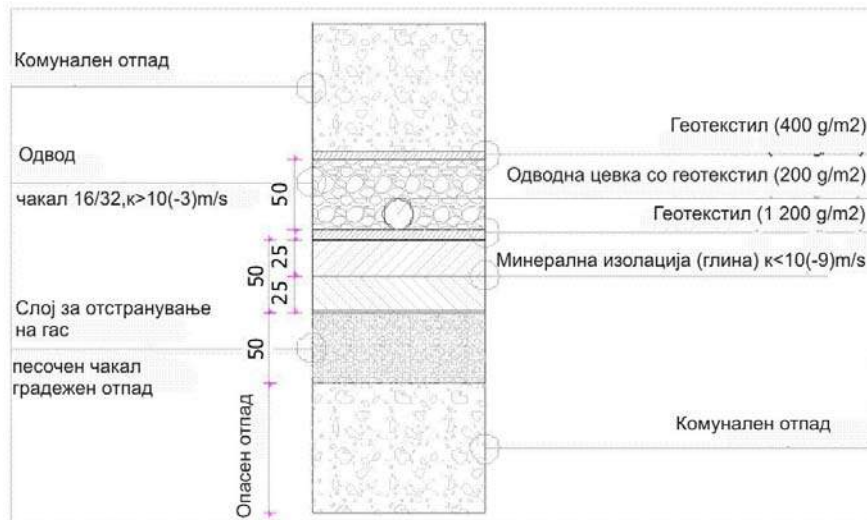
Слика 15. Обложување на основата на депонијата 2
