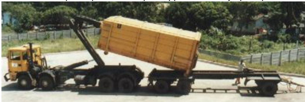
Слика 3-80: Транспортно возило претоварува полн контејнер на приколка
