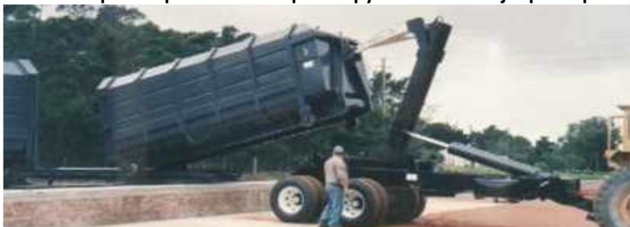
Слика 3-81: Транспортно возило претоварува полн контејнер на приколка
