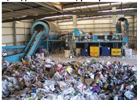
Слика 3-90: Место за истурање, подвижна лента, ротирачко сито, лента за рачно одделување
