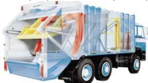
Слика 3-45: Пример за камион за собирање со преса
