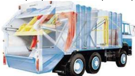
Слика 3-37: Пример за камион за собирање со преса
