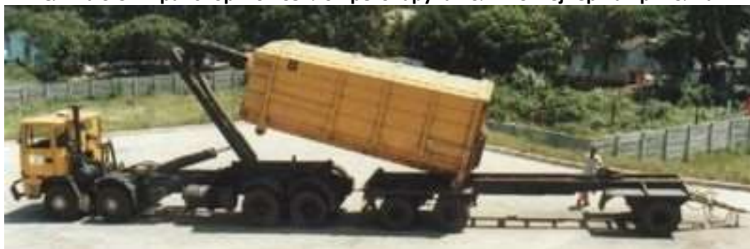
Слика 3-52: Транспортно возило претоварува полн контејнер на приколка
