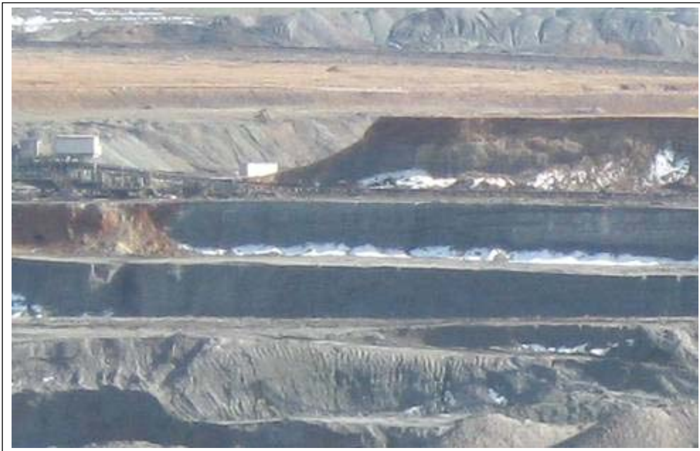
Слика бр.5: Етажен ископ на ПК „Осломеј-Запад“
