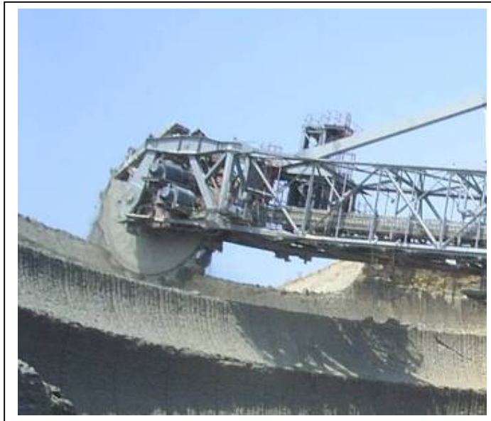
Слика бр.23: Ископување на јаловина со роторен багер
