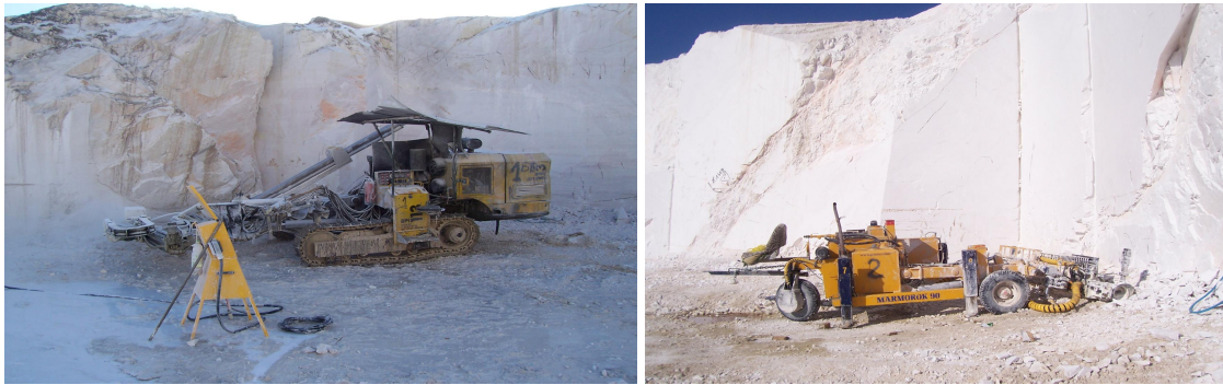
Слика 15 и 16 Изработка на вертикални и хоризонтални дупнатини - Дупчалка BOHLER и Дупчалка MARMOROC 90 (GEMSA)
