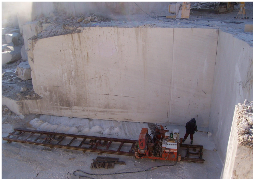
Слика 18 Каменорезна машина FANTINI за хоризонтално сечење
