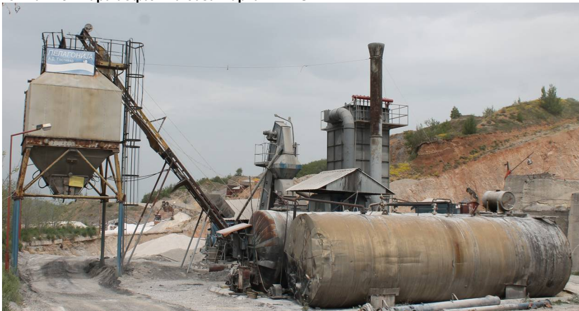
Слика II. 5 Стара асфалтна база марка TELTOMAT
