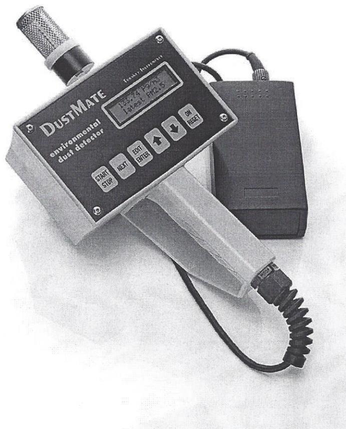
Слика бр.1; Инструмент за мерење на ниво на Квалитет на воздух - определување на вкупни суспендирани честици, респирабилни честици и фракција на ПМ 10 и ПМ 2.5 честици - тип TURNKEY DustMate kit
