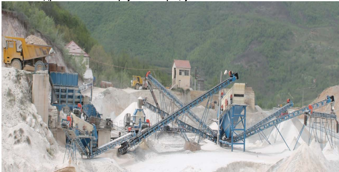
Слика II. 7 Дробилнична постројка и сепарација
