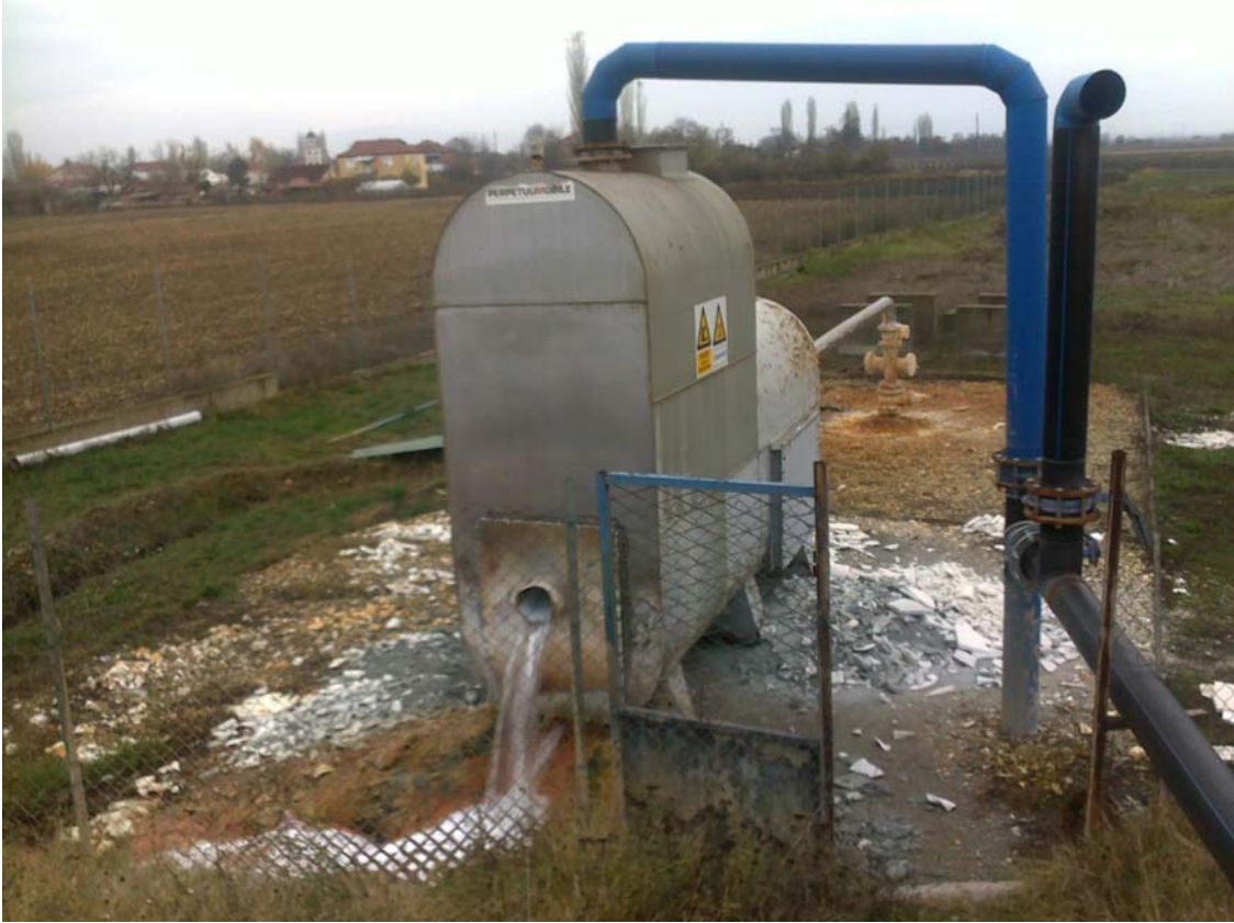
Слика бр.8 Извирате, сепарирање на суров гас од вода-DZ 1 (Сопственост на ГЕЛИ)
