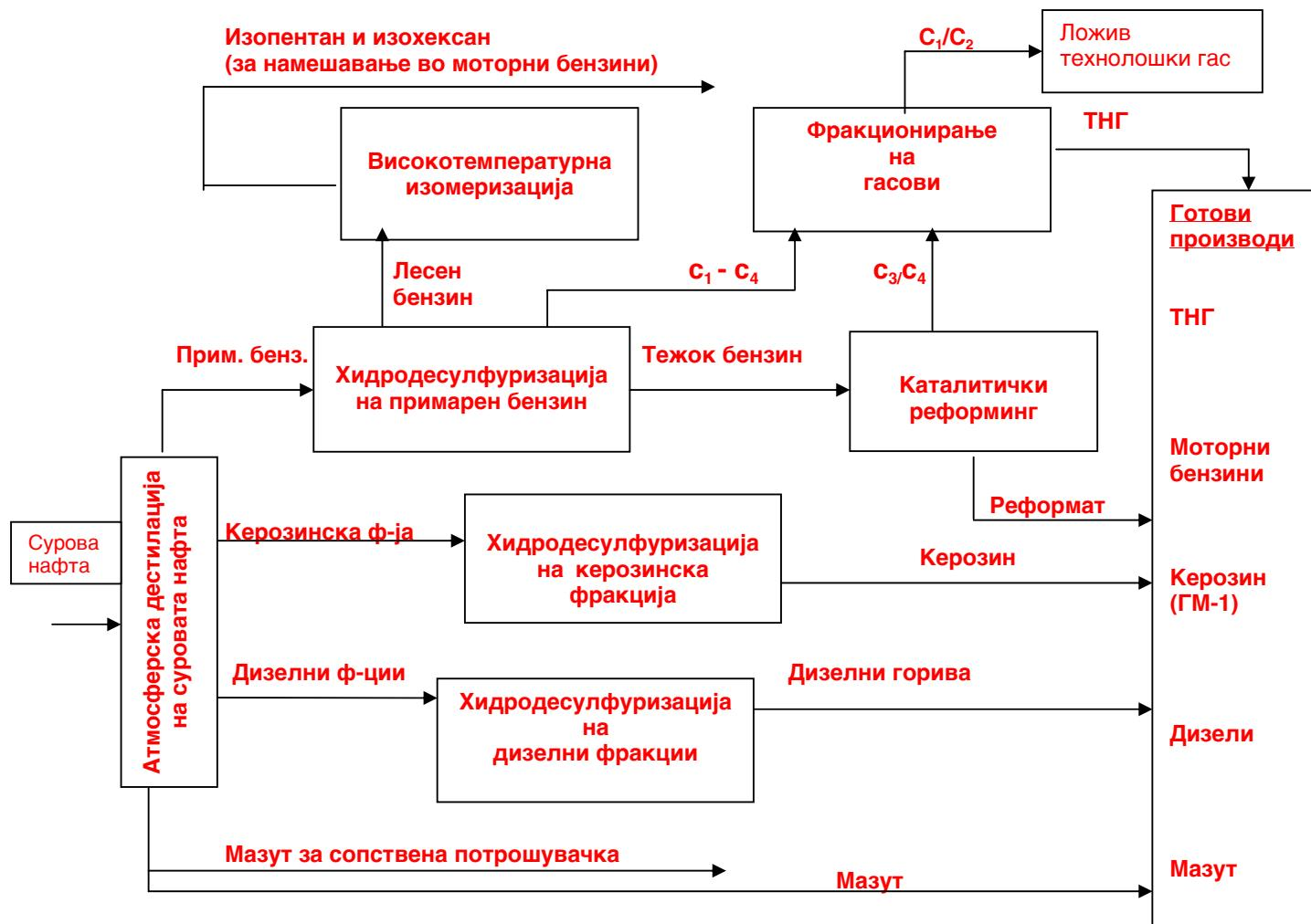
Во процесните постројки преку комбинација на физички и хемиски методи се врши примарна преработка на сировата нафта и понатамошна доработка на фракциите добиени во текот на технолошкиот процес. Технолошкиот процес на преработка на нафтата е сложен и се одвива во повеќе последователни етапи. За да се зголеми брзината на реакциите, селективноста на процесите и да се добие потребниот квалитет на производите, во одредени процесни постројки се користат катализатори.
