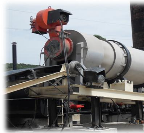
БАРАБАН ЗА СУШЕЊЕ, ЗАГРЕВАЊЕ И МЕШАЊЕ НА АСФАЛТНАТА МЕШАВИНА
