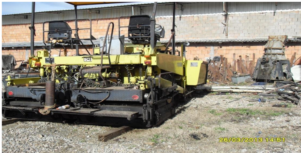
Финишер(ГРАДЕЖНА МАШИНА ЗА ВГРАДУВАЊЕ НА АСФАЛТ)
